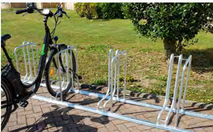
Fahrradständer L15 ET hergestellt aus Stahlrohr 21,3 mm und Bodenträger, Reihenständer, passend für alle Fahrradgrößen, feuerverzinkt nach DIN EN ISO 1461 wahlweise pulverbeschichtet nach RAL oder DB. Vom ADFC geprüft und empfohlen.
